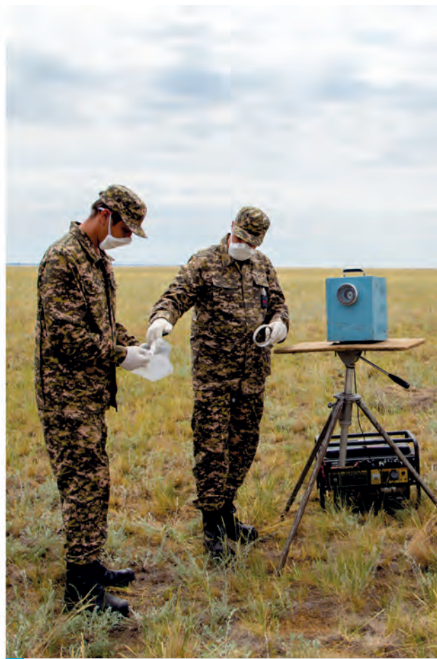
Отбор проб воздушных аэрозолей
