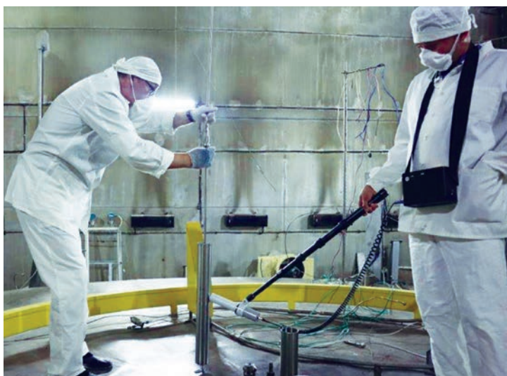
Выгрузка экспериментальной ТВС
